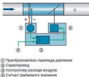
Рис. 9. Пример компоновки контроллера «Универсальный». Преобразователь давления, сервопривод и контроллер. Отдельные компоненты (из каталога «ТРОКС»)
